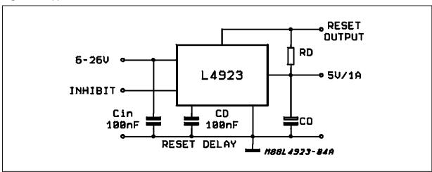
(\*) RECOMMENDED VALUE :  $C_0$  = 47  $\mu F$ , ESR < 10  $\Omega$ , ( $l_{out}$  > 10 mA) OVER FULL  $T_{range}$
